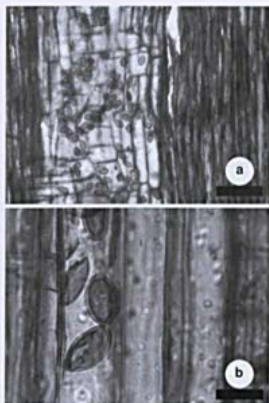
Figura 5 – Sinais de biodeterioração nas amostras identificadas como Andira sp. – a, ovipostura de insetos xilófagos ou esporos de fungos; b, detalhe da imagem 5a. Figure 5 – Anatomical signals of biodeterioration in the sample identified as Andira sp. – a, oviposition of wood attacking insects or fungal spores; b, image 5a detail.
