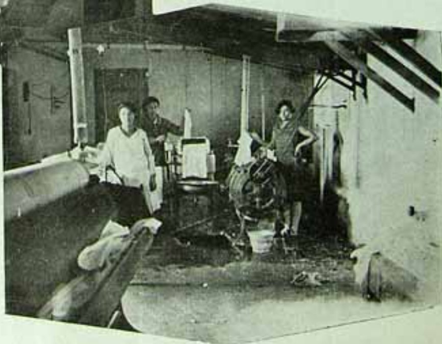
Um recanto da lavanderia, vendo-se uma das machinas em pleno funcionamento. A' di- reita, outro detalhe da mesma lavanderia, mos- trando a montagem optima que, em cinco (5) minutos, lava e passa um terno de roupa.
