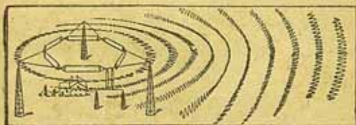
A gravura demonstra a maneira como actuam as ondas pulverizadas, quando se lançam ao espaço por meio de uma antena horizontal multipla syntonizada, como se descreve neste artigo.
