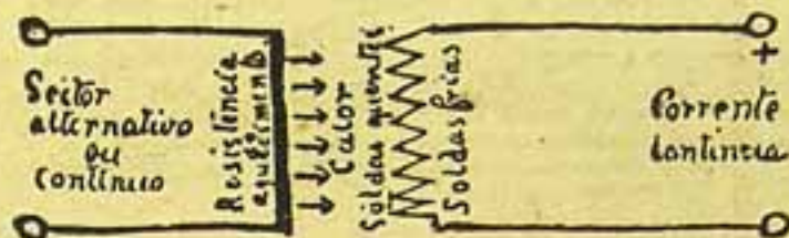
(Fig. 2) — Principio do thermotransformador
